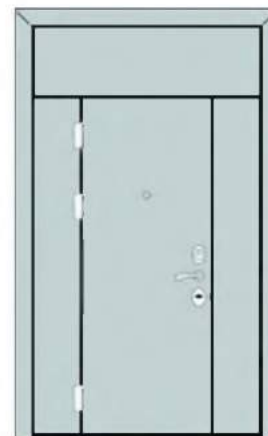
тристулкова з верхньою та боковими фрамугами трёхстворка с верхней и боковыми фрамугами
